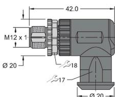
Connecteur mâle confectionnable, M12 x 1, coudé, 5 pôles, raccordement par borne à vis, diamètre de ligne 4,0 à 8,0 mm, section conducteur/section raccordable 0,25 à 1,5 mm<sup>2</sup>, boîtier plastique, vis de montage métallique
