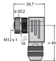
Connecteur femelle confectionnable, M12 x 1, coudé, 5 pôles, raccordement par borne à vis, diamètre de ligne 6.0 à 8.0 mm, section conducteur/section raccordable 0,14 à 0.75 mm<sup>2</sup>, boîtier métallique, écrou de montage métallique, peut être blindé
