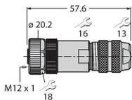
Connecteur femelle confectionnable, M12 x 1, droit, 5 pôles, raccordement par borne à vis, diamètre de ligne 6.0 à 8.0 mm, section conducteur/section raccordable 0,14 à 0.75 mm<sup>2</sup>, boîtier métallique, écrou de montage métallique, peut être blindé
