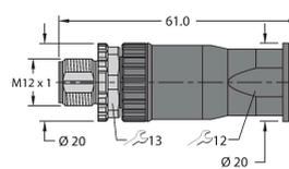
Connecteur mâle confectionnable, M12 x 1, droit, 4 pôles, raccordement par borne à vis, diamètre de ligne 4.0 à 8.0 mm, section conducteur/section raccordable 00:25 à 1.5 mm<sup>2</sup>, boîtier plastique, vis de montage métallique
