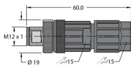
Connecteur mâle confectionnable, M12 x 1, droit, 4 pôles, raccordement Push-In, diamètre de ligne 4,0 à 8,0 mm, section conducteur/section raccordable 0,14 à 0,75 mm<sup>2</sup>, boîtier plastique, vis de montage métallique
