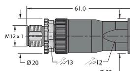
Connecteur mâle confectionnable, M12 x 1, droit, 4 pôles, raccordement par borne à vis, diamètre de ligne 4.0 à 8.0 mm, section conducteur/section raccordable 00:25 à 1.5 mm<sup>2</sup>, boîtier plastique, vis de montage métallique
