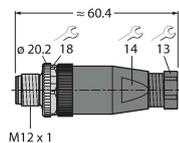
Connecteur mâle confectionnable, M12 x 1, droit, 4 pôles, raccordement par borne à vis, diamètre de ligne 4,0 à 6,0 mm, section conducteur/section raccordable 0,14 à 0,75 mm<sup>2</sup>, boîtier plastique, vis de montage métallique
