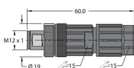
Connecteur mâle confectionnable, M12 x 1, droit, 4 pôles, raccordement Push-In, diamètre de ligne 4,0 à 8,0 mm, section conducteur/section raccordable 0,14 à 0,75 mm<sup>2</sup>, boîtier plastique, vis de montage métallique
