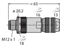
Connecteur mâle confectionnable, M12 x 1, droit, 5 pôles, raccordement par borne à vis, diamètre de ligne 6.0 à 8.0 mm, section conducteur/section raccordable 0,14 à 0.75 mm<sup>2</sup>, boîtier métallique, écrou de montage métallique, peut être blindé
