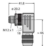
Connecteur mâle confectionnable, M12 x 1, coudé, 5 pôles, raccordement par borne à vis, diamètre de ligne 6.0 à 8.0 mm, section conducteur/section raccordable 0,14 à 0.75 mm<sup>2</sup>, boîtier métallique, écrou de montage métallique, peut être blindé
