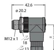
Connecteur mâle confectionnable, M12 x 1, coudé, 5 pôles, raccordement par borne à vis, diamètre de ligne 4,0 à 6,0 mm, section conducteur/section raccordable 0,14 à 0,75 mm<sup>2</sup>, boîtier plastique, vis de montage métallique
