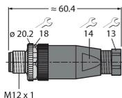
Connecteur mâle confectionnable, M12 x 1, droit, 5 pôles, raccordement par borne à vis, diamètre de ligne 4,0 à 6,0 mm, section conducteur/section raccordable 0,14 à 0,75 mm<sup>2</sup>, boîtier plastique, vis de montage métallique
