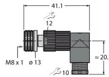
Connecteur femelle confectionnable, M8 x 1, coudé, 3 pôles, technique de pénétration, diamètre de ligne 4.0 à 5.0 mm, section conducteur/section raccordable 0,14 à 0,34 mm<sup>2</sup>, boîtier plastique, écrou de montage métallique
