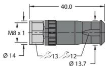
Connecteur femelle confectionnable, M8 x 1, droit, 3 pôles, raccordement par borne à vis, diamètre de ligne 4.0 à 5.5 mm, section conducteur/section raccordable 0,14 à 0,5 mm<sup>2</sup>, boîtier plastique, écrou de montage métallique
