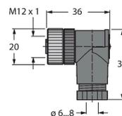
Connecteur femelle confectionnable, M12 x 1, coudé, 8 pôles, raccordement par borne à vis, diamètre de ligne 6.0 à 8.0 mm, section conducteur/section raccordable 0,14 à 0.50 mm<sup>2</sup>, boîtier plastique, écrou de montage métallique
