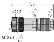
Connecteur femelle confectionnable, M12 x 1, droit, 8 pôles, raccordement par borne à vis, diamètre de ligne 6.0 à 8.0 mm, section conducteur/section raccordable 0,14 à 0.50 mm<sup>2</sup>, boîtier métallique, écrou de montage métallique, peut être blindé
