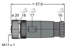
Connecteur femelle confectionnable, M12 x 1, droit, 8 pôles, raccordement par borne à vis, diamètre de ligne 6.0 à 8.0 mm, section conducteur/section raccordable 0,14 à 0.50 mm<sup>2</sup>, boîtier plastique, écrou de montage métallique
