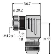
Connecteur femelle confectionnable, M12 x 1, coudé, 8 pôles, raccordement par borne à vis, diamètre de ligne 6.0 à 8.0 mm, section conducteur/section raccordable 0,14 à 0.50 mm<sup>2</sup>, boîtier métallique, écrou de montage métallique, peut être blindé
