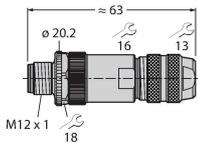
Connecteur mâle confectionnable, M12 x 1, droit, 8 pôles, raccordement par borne à vis, diamètre de ligne 6,0 à 8,0 mm, section conducteur/section raccordable 0,14 à 0,50 mm<sup>2</sup>, boîtier métallique, écrou de montage métallique, peut être blindé, e.a. pour Ethernet
