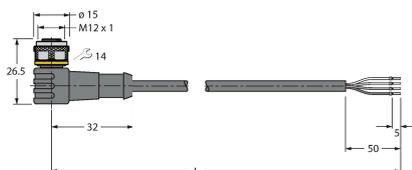
Câble de raccordement, connecteur femelle M12, coudé, 4 broches, longueur de câble : 2 m, matériau de la gaine : PVC, noir ; homologation cULus
