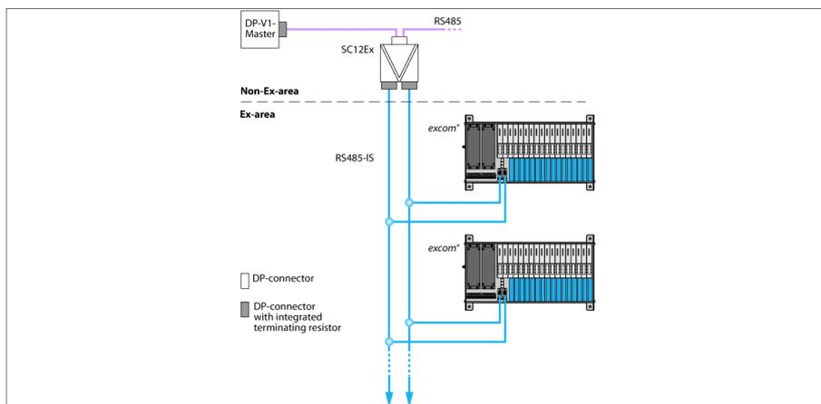
Le coupleur de segment PROFIBUS-DP SC12Ex de TURCK a été conçu pour le raccordement PROFIBUS à sécurité intrinsèque.
