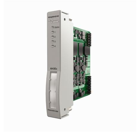
Le module d'entrée analogique AI43Ex sert de la connexion de potentiometres en technique 3 ou 4 fils. En cas d'utilisation de potentiometres en technique 3 fils, un pontage aux bornes de raccordement à la platine est exigé. Des mesures de résistance, ainsi que l'évaluation de potentiometres avec raccordement en technique 2 fils ne sont pas possibles.
