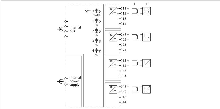
Le module de sortie AO40-N est conçu pour le raccordement d'actuateurs analogiques tels que les vannes de commande ou les indicateurs de processus.
