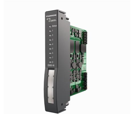
Le module d'entrée digital DI80-N sert de la connexion de huit détecteurs 3 fils PNP/NPN (IEC 61131, Type 3). Le détecteur n'est pas alimenté par le module, mais protégé contre les inversions de polarité par une énergie auxiliaire, qui est apporté séparément pour les canaux 1...4 (groupe 1) et 5...8 (groupe 2) à l'externe par les bornes de raccordement. Les groupes d'entrée sont séparés galvaniquement l'un de l'autre.
