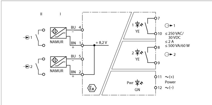
L'amplificateur séparateur à 2 canaux du type IM12-22EX-R/24VDC est équipé de circuits d'entrée à sécurité intrinsèque.
