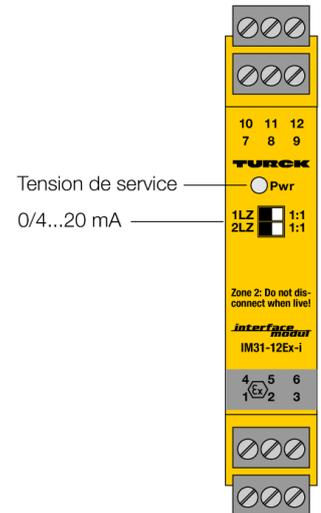
Les signaux de tension ou de courant actifs normalisés sont séparés galvaniquement par le séparateur de signaux à deux canaux IM31-12EX-I et ensuite transmis de la zone Ex à la zone non Ex. Le signal est dupliqué et est disponible alors aux deux sorties.
