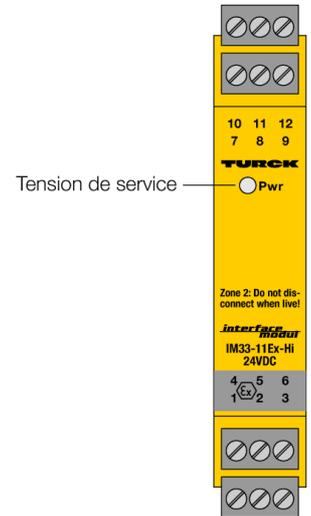
Par le convertisseur de mesure-séparateur d'alimentation monocanal HART®IM33-11EX-HI/24VDC, des convertisseurs de mesure 2 fils (III) à sécurité intrinsèque HART® sont alimentés dans la zone Ex et le signal de mesure transmis dans la zone non Ex. Sauf les signaux analogiques il est également possible de transmettre bidirectionnellement les signaux numériques de la communication HART®.
