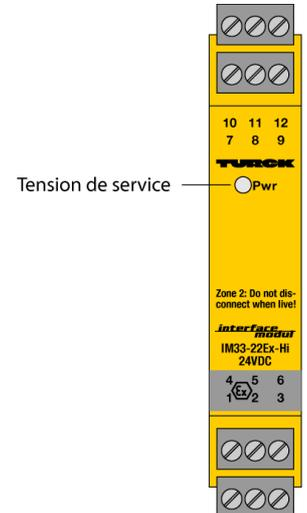
Par le convertisseur de mesure-séparateur d'alimentation IM33-22EX-HI à deux canaux HART® permet d'alimenter des convertisseurs de mesure 2 fils (III) à sécurité intrinsèque HART® dans la zone Ex et de transmettre les signaux de mesure dans la zone non Ex. Sauf les signaux analogiques il est également possible de transmettre bidirectionnellement les signaux numériques de la communication HART®.
