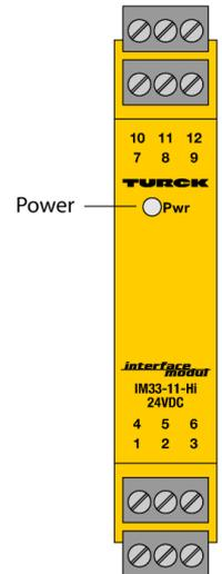
Par le convertisseur de mesure-séparateur d'alimentation monocanal HART®IM33-11-HI/24VDC, des convertisseurs de mesure 2 fils (III) à sécurité intrinsèque HART®sont alimentés et le signal de mesure transmis avec séparation galvanique. Sauf les signaux analogiques il est également possible de transmettre bidirectionnellement les signaux numériques de la communication HART®.
