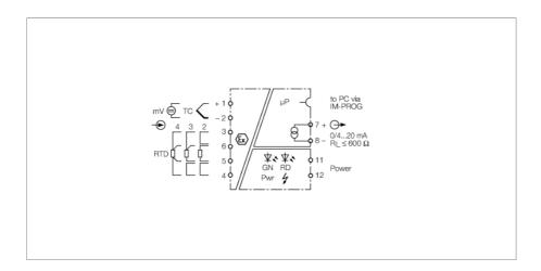
L'amplificateur de température du type IM34-11EX-CI/K70 permet d'évaluer les modifications dépendantes de la température de résistances Ni100/Pt100, de thermocouples des types B, E, J, K, L, N, R, S et T ou de tensions faibles dans la plage de -160...+160 mV et de les sortir comme signaux de courant linéaire à la température.
