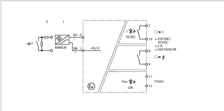
L'amplificateur séparateur monocanal du type IM1-121EX-R est équipé d'un circuit d'entrée à sécurité intrinsèque.
