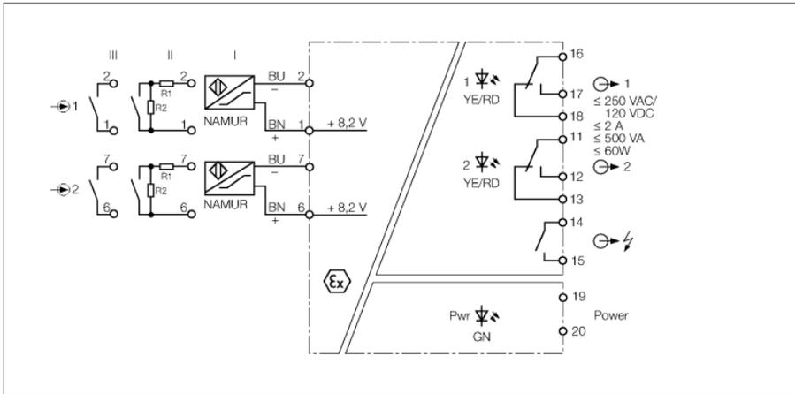
L'amplificateur séparateur à 2 canaux du type IM1-231EX-R est équipé de circuits d'entrée à sécurité intrinsèque.
