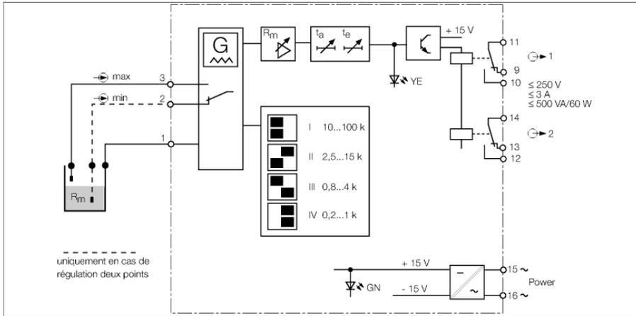
Le contrôleur de niveaux monocanal MK91-12-R/230VAC permet de surveiller et de régler le niveau de liquides conducteurs.
