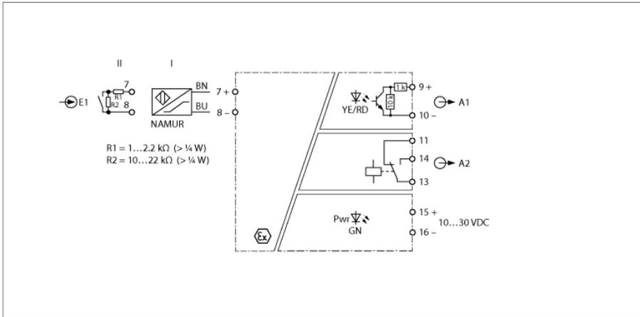
Des détecteurs suivant EN 60947-5-6 (NAMUR) ou des contacts libres de potentiel peuvent être raccordés au répéteur NAMUR IMX12-DI03-1S-1NAM1R-0/24VDC. L'appareil est équipé d'un circuit d'entrée à sécurité intrinsèque et peut être monté en zone 2. Le circuit de sortie est de plus équipé de 1 sortie par relais. L'appareil répond aux exigences de la NE21.
