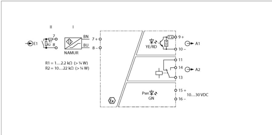
Des détecteurs suivant EN 60947-5-6 (NAMUR) ou des contacts libres de potentiel peuvent être raccordés au répéteur NAMUR IMX12-DI03-1S-1NAM1R-0/24VDC/CC. L'appareil est équipé d'un circuit d'entrée à sécurité intrinsèque et peut être monté en zone 2. Le circuit de sortie est de plus équipé de 1 sortie par relais. L'appareil répond aux exigences de la NE21.
