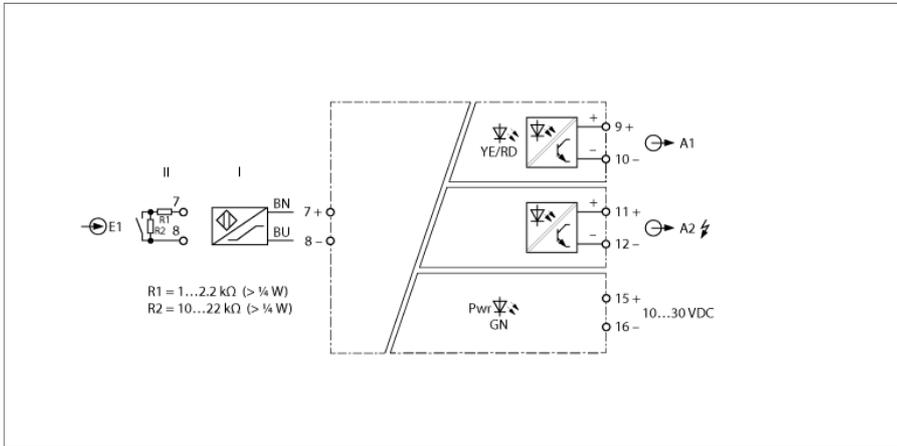
Des détecteurs suivant EN 60947-5-6 (NAMUR) ou des contacts libres de potentiel peuvent être raccordés à l'amplificateur séparateur IM12-DI03-1S-2T-S-/24VDC/CC. L'appareil peut être monté en zone 2. L'appareil peut basculer via des commutateurs DIP entre un fonctionnement à un canal avec double signalisation ou à un canal avec sortie d'alarme. Les circuits de sortie sont équipés de deux transistors libres de potentiel. L'appareil répond aux exigences de la NE21.
