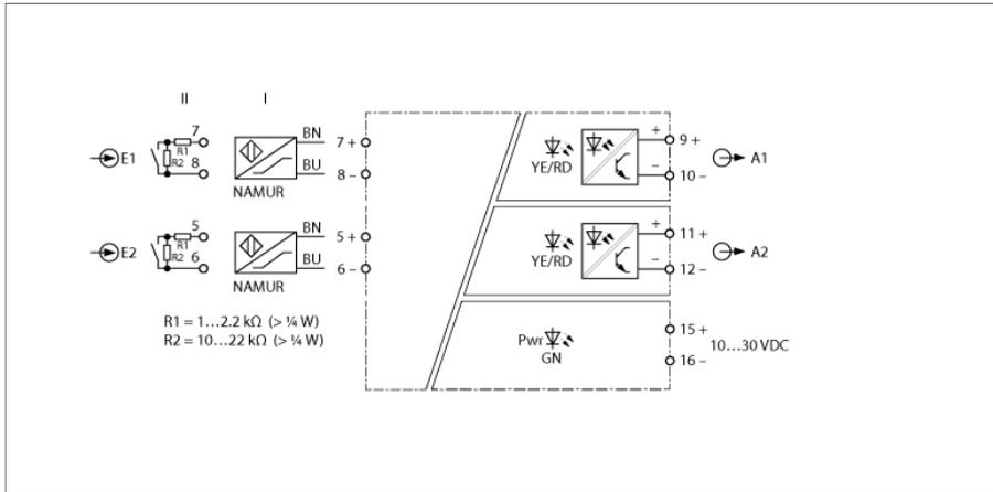
Des détecteurs conformément à EN 60947-5-6 (NAMUR) ou des contacts libres de potentiel peuvent être raccordés à l'amplificateur séparateur IM12-DI01-2S-2T-0/24VDC. L'appareil peut basculer via des commutateurs DIP entre un fonctionnement à deux canaux ou à un canal avec double signalisation. Les circuits de sortie sont équipés de deux transistors sans potentiel avec fréquence-limite élevée (10 kHz). L'appareil répond aux exigences de la NE21.
