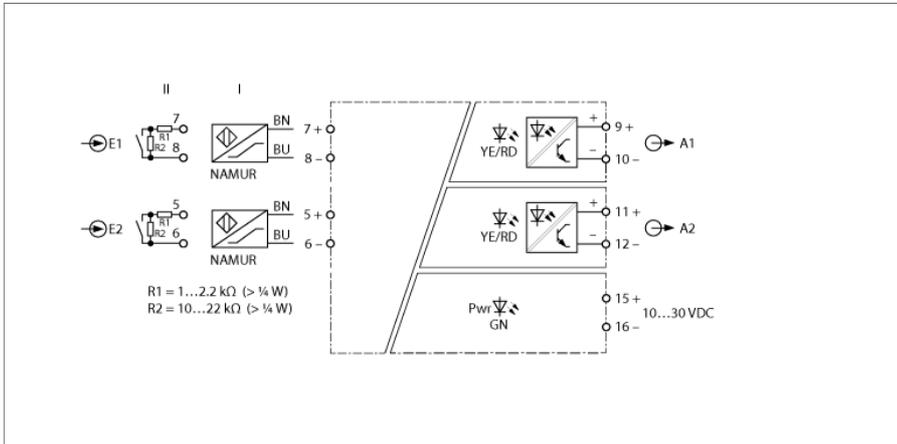
Des détecteurs suivant EN 60947-5-6 (NAMUR) ou des contacts libres de potentiel peuvent être raccordés à l'amplificateur séparateur IM12-DI01-2S-2T-/24VDC/CC. L'appareil peut basculer via des commutateurs DIP entre un fonctionnement à deux canaux ou à un canal avec double signalisation. Les circuits de sortie sont équipés de deux transistors sans potentiel avec fréquence-limite élevée (10 kHz). L'appareil répond aux exigences de la NE21.
