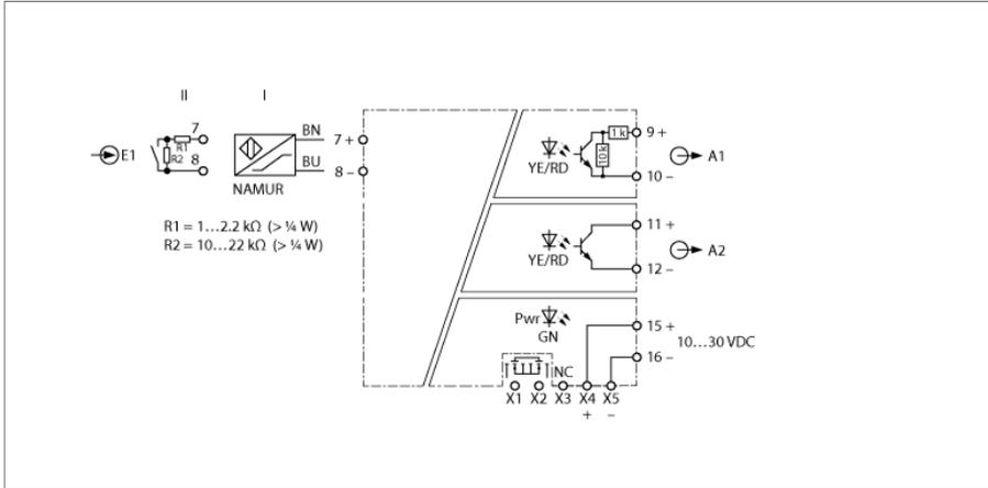
Des détecteurs suivant EN 60947-5-6 (NAMUR) ou des contacts libres de potentiel peuvent être raccordés au répéteur NAMUR IM12-DI03-1S-1NAM1T-PR/24VDC. L'appareil peut être monté en zone 2. Le circuit de sortie est de plus équipé d'une sortie transistorisée. L'appareil peut être alimenté par un Power-Bridge, qui transmet aussi une alarme collective. L'appareil répond aux exigences de la NE21.
