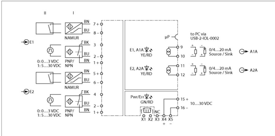
Le convertisseur de mesure de fréquence/puls-counter IM12-FI01-2SF-2I-CPR/24VDC/CC transmet les signaux de fréquence jusqu'à 20 000 Hz séparés galvaniquement. De plus, les signaux d'entrée peuvent être surveillés au glissement. Les appareils se prêtent au fonctionnement dans la zone 2.
