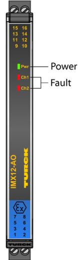
Le signal de courant normalisé est séparé galvaniquement par le séparateur de signaux à deux canaux IMX12-AO01-2I-2I-H0/24VDC de la zone non-Ex à la zone Ex. Sauf le signal analogique il est également possible de transmettre bidirectionnellement les signaux numériques de la communication HART®. Des applications typiques sont la commande de convertisseurs I/P ou d'appareils d'affichage dans la zone Ex.
