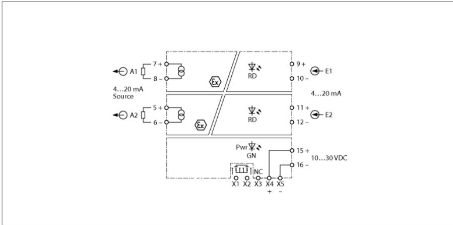
Le signal de courant normalisé est séparé galvaniquement par le séparateur de signaux à 2 canaux IMX12-AO01-2I-2I-HPR/24VDC/CC de la zone non-Ex à la zone Ex. Sauf le signal analogique il est également possible de transmettre bidirectionnellement les signaux numériques de la communication HART®. Des applications typiques sont la commande de convertisseurs I/P ou d'appareils d'affichage dans la zone Ex.
