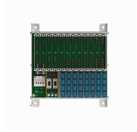
La platine MT08-3G comprend un Backplane et le système de support propre. Elle sert de l'intégration d'une passerelle, d'un appareil d'alimentation et de 8 modules E/S. Jusqu'à 64 entrées/sorties binaires ou 32 entrées/sorties analogiques resp. chaque combinaison peuvent être raccordées à la platine.
