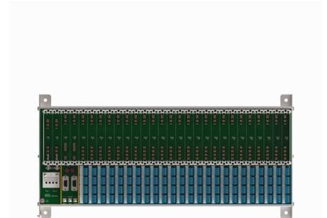
La platine MT24-3G comprend un Backplane et le système de support propre. Elle sert de l'intégration de deux passerelles, de deux appareils d'alimentation et de 24 modules E/S. Jusqu'à 192 entrées/sorties binaires ou 96 entrées/sorties analogiques resp. chaque combinaison peuvent être raccordées à la platine.
