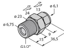
Raccordement par bague de serrage pour le montage direct de sondes de température ; diamètre sonde 6 mm ; raccordement au processus filetage extérieur G1/2"
