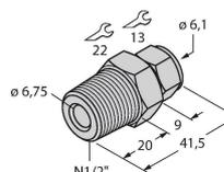
Raccordement par bague de serrage pour le montage direct de sondes de température ; diamètre sonde 6 mm ; raccordement au processus filetage extérieur 1/2" NPT
