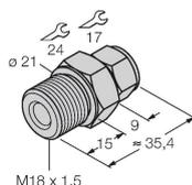
Raccordement par bague de serrage pour le montage direct de sondes de température ; diamètre sonde 6 mm ; raccordement au processus filetage extérieur M18x1
