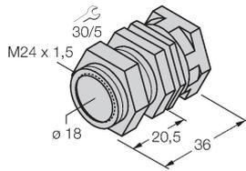
Зажим-фиксатор для быстрой установки; материал: Хромированная латунь. Наружная резьба M24 × 1,5. Примечание. При использовании кронштейнов для быстрого монтажа дистанция переключения датчиков приближения может меняться.
