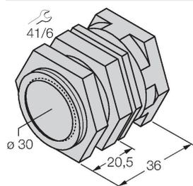
Зажим-фиксатор для быстрой установки; материал: Хромированная латунь. Наружная резьба M36 × 1,5. Примечание. При использовании кронштейнов для быстрого монтажа дистанция переключения датчиков приближения может меняться.
