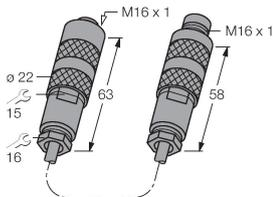
Адаптерный кабель позволяет отдельно устанавливать кольцевой датчик и переключающий усилитель; коаксиальный кабель: RG58 C/U 50 Ом
