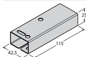
Защитный корпус для инклинометров Q20L60 для защиты от механических воздействий; материал: Нержавеющая сталь
