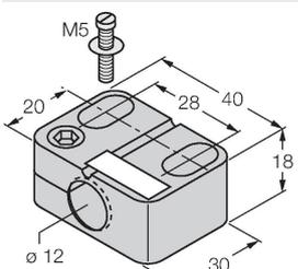
Монтажный зажим для цилиндрических резьбовых датчиков, с упором; материал: PA6
