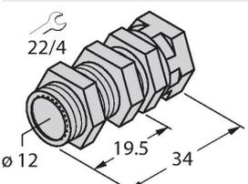
Зажим-фиксатор для быстрой установки; материал: Хромированная латунь. Наружная резьба M16 × 1. Примечание. При использовании кронштейнов для быстрого монтажа дистанция переключения датчиков приближения может меняться.
