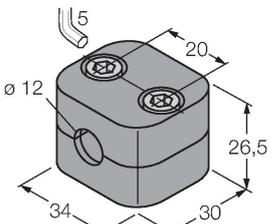
Монтажный зажим для цилиндрических гладких и резьбовых датчиков; материал: Полипропилен
