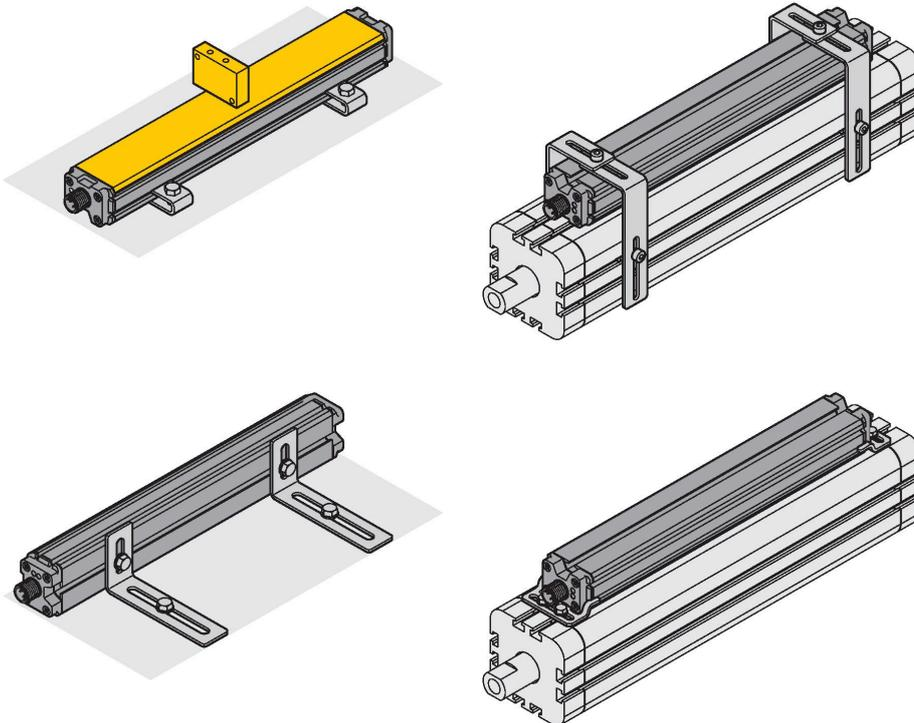
Множество аксессуаров позволяет различные варианты монтажа датчика. Датчик имеет монтажный паз напротив активной поверхности, для которого имеются монтажные блоки. Боковой паз также может быть использован для монтажа.
