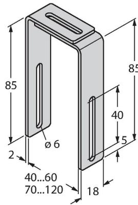
Монтажный кронштейн для установки датчиков линейного перемещения Q25L на пневматические цилиндры (40...60 мм); материал: Нержавеющая сталь; 4 шт. в упаковке
