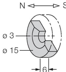
Магнит для активации Ø 15 мм (Ø 3 мм), h: 6 мм; достигаемая дистанция переключения 36 мм для датчиков магнитного поля BIM-(E)M12 и 32 мм для датчиков BIM-EG08; в комбинации с датчиками линейного перемещения Q25L: рекомендуемая дистанция между датчиком и магнитом: 3 ... 4 мм
