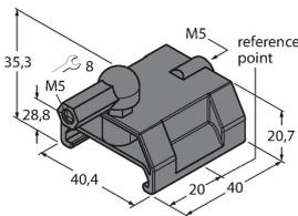
Направляемый позиционирующий элемент для WIM-Q25L, вставлен в паз датчика.
