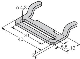
Монтажные зажимы для датчиков линейного перемещения Q25L; материал: нержавеющая сталь; 2 шт. в пакете
