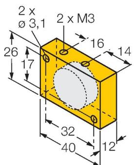
Актуатор, прямоугольный, пластиковый; достигаемая дистанция переключения 58 мм для датчиков магнитного поля BIM-(E)M12 и 49 мм для датчиков BIM-EG08; в комбинации с датчиками линейного перемещения Q25L: рекомендуемая дистанция между датчиком и магнитом: 3 ... 5 мм
