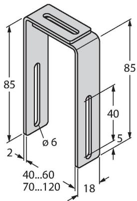
Монтажный кронштейн для установки датчиков линейного перемещения Q25L на пневматические цилиндры (70...120 мм); материал: Нержавеющая сталь; 4 шт. в упаковке
