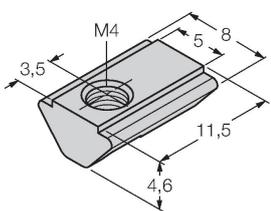
Скользящий блок с резьбой M4 для тыльного профиля датчика LI-Q25L; Материал: оцинкованная сталь; 10 шт. в упаковке
