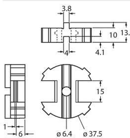
Проставка для комплекта актуатора сдвоенных датчиков BTS-DSC26-EB20
