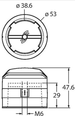
Актуатор (позиционирующий элемент) для сдвоенных датчиков; демпф. конечное положение; схема отверстий на поверхности соединителя: 80 x 30 мм и 130 x 30 мм; высота соединительного вала (удлинитель вала): 30 мм / Ø: макс. 35 мм; доступно в качестве опции: Проставка BTS-DSC26-UR10 для соединительных валов высотой 20 мм (удлинитель вала)
