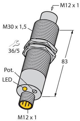
Сигнальный процессор для датчика 250 °С; материал корпуса: Нержавеющая сталь 1.4571; степень защиты: IP67; функциональный дисплей: светодиод/желтый, индикация включения: светодиод/зеленый, температура окружающей среды -25 °С...+70 °С
