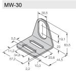
6945005 Монтажный кронштейн для цилиндрических резьбовых датчиков; материал: Нержавеющая сталь A2 1.4301 (AISI 304)
