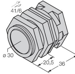
Кронштейн для быстрого монтажа со стопором; материал: латунь с покрытием PTFE; наружная резьба M36 × 1,5. Примечание. При использовании кронштейнов для быстрого монтажа дистанция переключения датчиков приближения может меняться.
