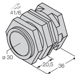
Зажим-фиксатор для быстрой установки; материал: Хромированная латунь. Наружная резьба M36 × 1,5. Примечание. При использовании кронштейнов для быстрого монтажа дистанция переключения датчиков приближения может меняться.
