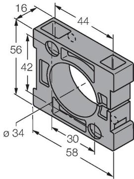
зажим-фиксатор: материал монтажного блока (PBT-GF20-V0); размеры (58 мм x 56 мм x 16 мм), включены в поставку (2 винта M5 для базового монтажа)
