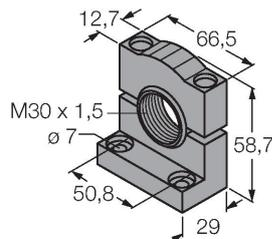
Монтажный зажим, РВТ черн., для датчиков с резьбой 30 мм, поворотный
