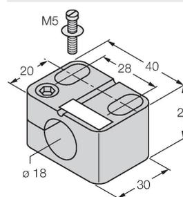
Монтажный зажим для цилиндрических резьбовых датчиков, без упора; материал: PA6
